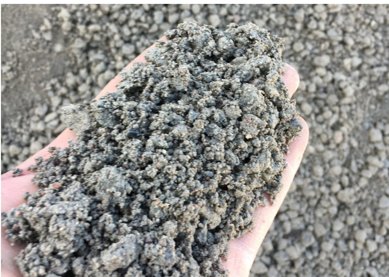
Krossad returbetong från byggarbetsplats.
